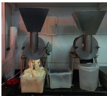
Figura 2. Moinho elétrico para preparação da massa do acarajé e abará.
